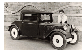
1931 DKW F1 mit Zweitaktmotor und Frontantrieb
